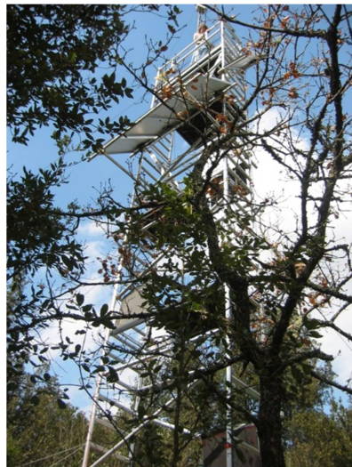
Stazione di misura del flusso di ozono
